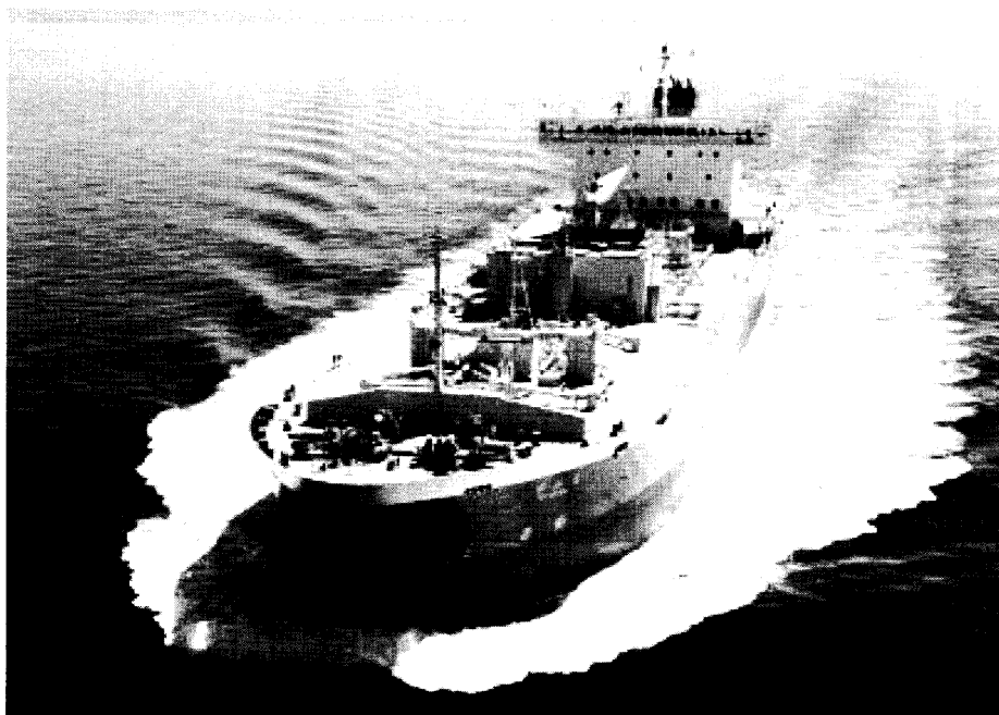
（船種）20,000トン積ハイブリッド推進システム採用セメント専用船 （竣工）平成22年8月30日
