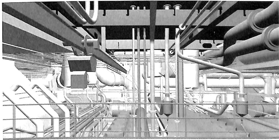
▲機関室から排煙部に至るハイピング・ダクティング・ケーシング等の立体表現モデル (Virtual Model)
