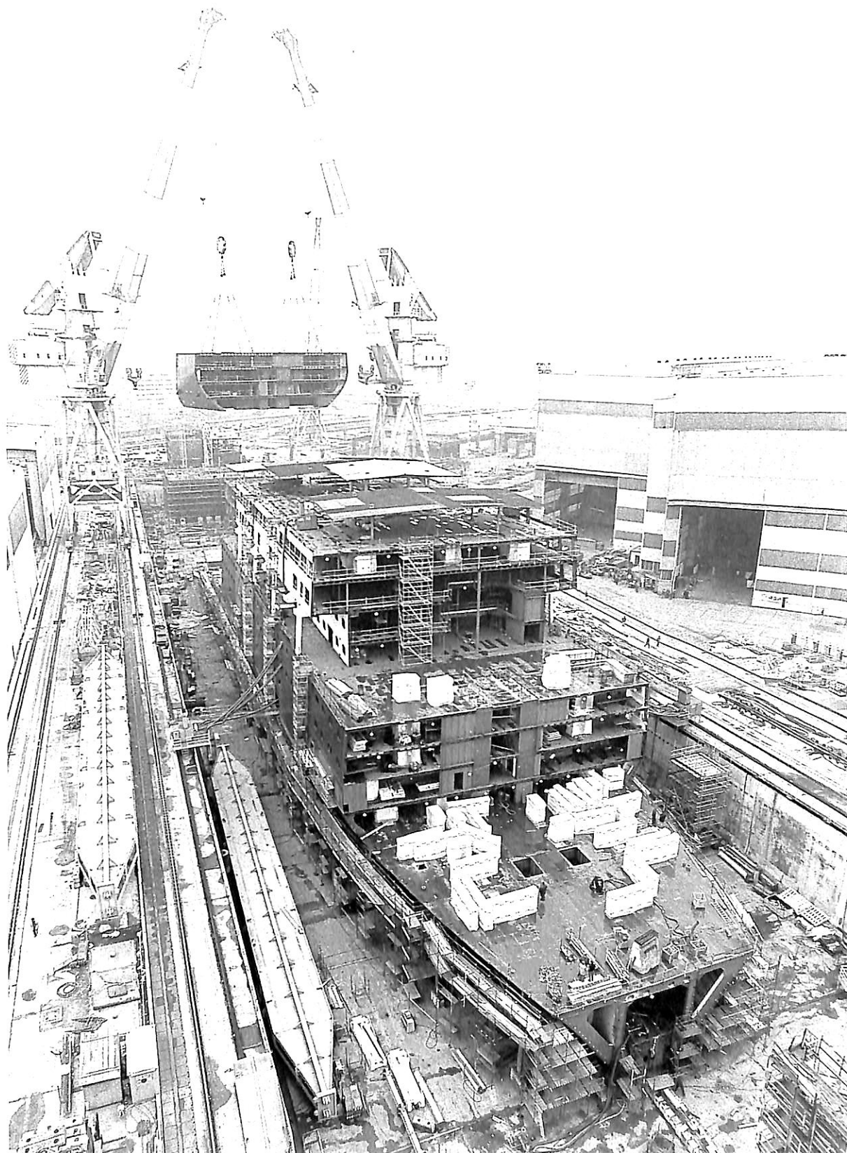
▲1998年1月13日の撮影、ベニス近郊のフィンカンティエリ社のマルケーラ造船所の ドライドック内でのブロック建造の様子、手前が船首“AMSTERDAM”
