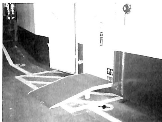
▲写真2 車両甲板階段室出入口に設けられた 取外し式斜路 (B 船, C 船)
