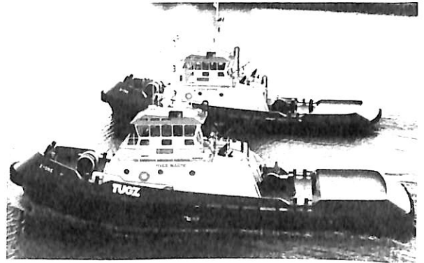
▲写真9 3516B形搭載の多目的タグボート
