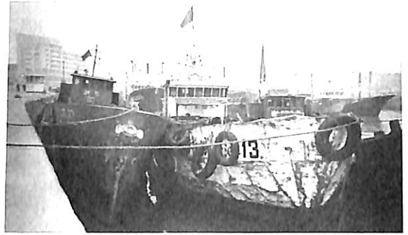
▲ 引潮時の漁船扱いが荒いので洗濯板のようになっている
