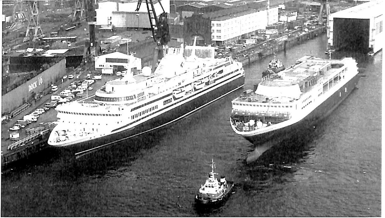
▲ドイツのハンブルグにあるBlohm + Voss社の艦装岸壁に係留中の“オリンピックボイジャー”右側は、姉妹船“オリンピックエクスプローラー”ドック内での船体建造が終了し、艦装岸壁にシフトされるところ
