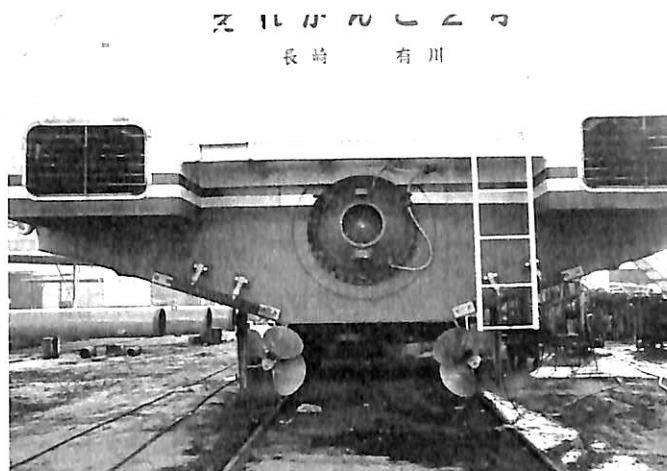
船尾を見る 中央機としてカメワウォータージェット56B11が使用されており、左右プロペラ2基はナカシマハイスキュープロペラである
