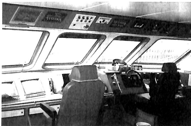
◀ 操舵室後方より中央及び右方を見る中央コントロール上部パネルは電気関係のモニター、コントロール関係
