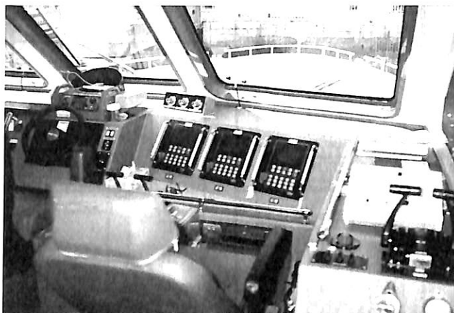
◀ 操舵室右舷後方より前方を見るエンジンモニターが3台前方に見える、右手前はエンジンリモコン及び操舵機のリモコンコード
