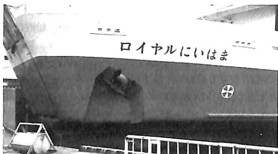
▲ [ロイヤルにいはま] 船首、トラック甲板部が大きく左右に張り出しているため、台風の時など波浪の影響で最も弱い部分であった
