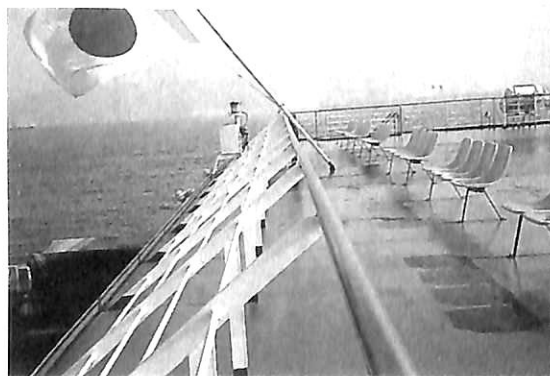
▲ 後部甲板、内側に傾斜させた手摺
