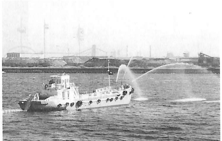
▲ オイルフェンス展張、放水、油処理散布テスト中の“若葉”
