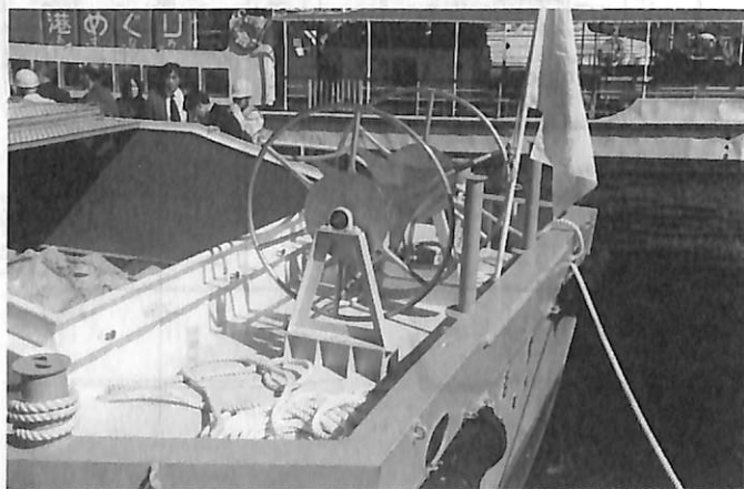
▲ 船尾オイルフェンス格納庫と展張装置
