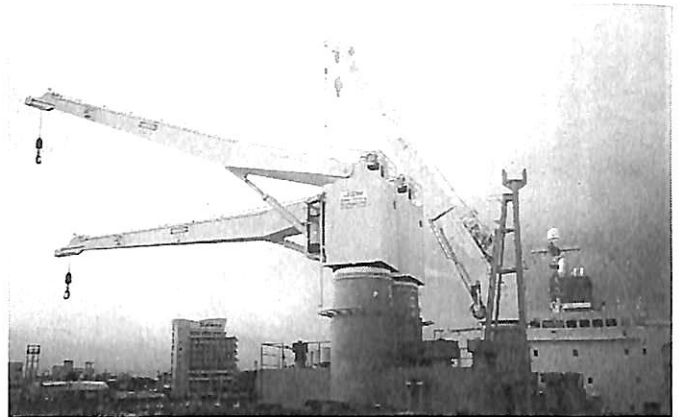
▲ コンテナ、パレット双方の荷役に最適なデッキクレーン配置
