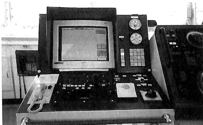
▲ DPS操船コンソールとINS画面
