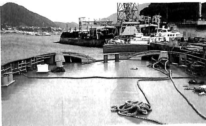
▲ 船尾作業甲板（中央奥に昇降型ダブルトーピンが見える）
