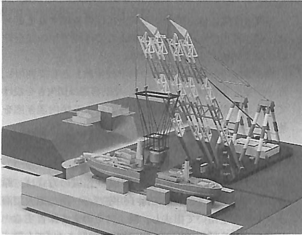
▲ 図2 原子炉室一括撤去移送方式
