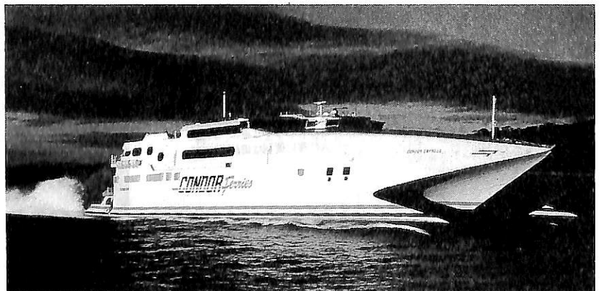
▲ 第1図 “CONDOR EXPRESS” 旅客 800 名 / 車輛 200 台搭載 / 最大速力 44 kn
