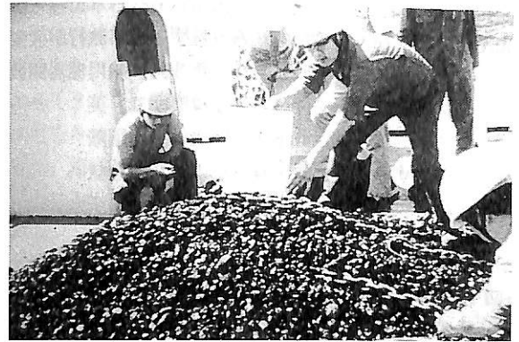
▲ 図 24-4 第2白嶺丸の甲板上にバケツ方式で揚げられたマンガン団塊の山
