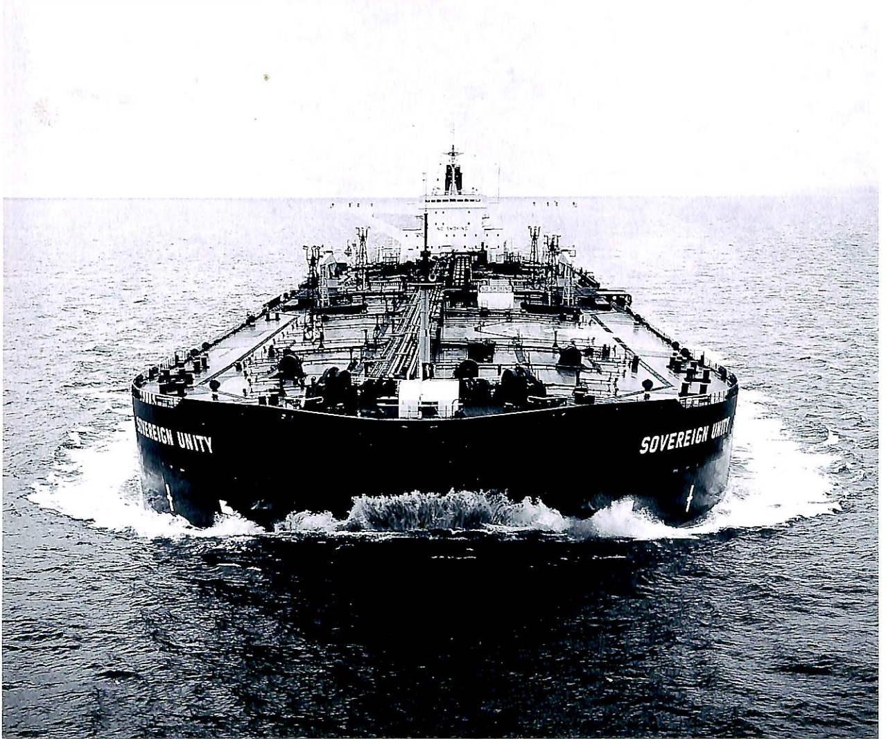
Majestic Tankers Corporation 向けタンカー / 載貨重量307,000t / 速力16.17kn
