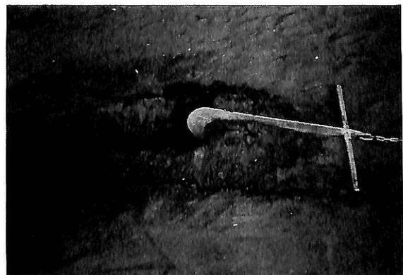
▲写真-4 抵抗力220kgで移動するJIS型アンカー
