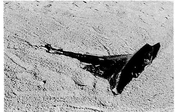
▲ 写真-9 DA-1型アンカー (静置時)
