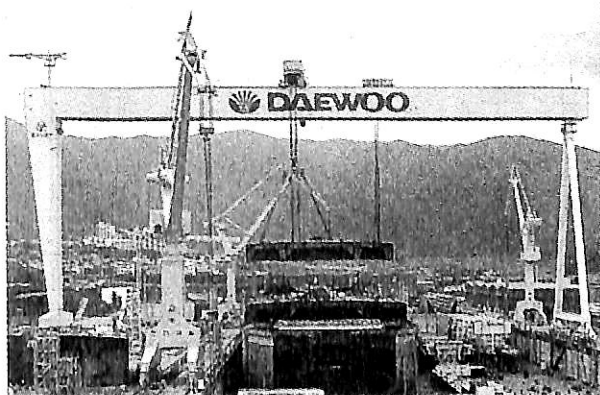
▲写真5 大宇造船所 No.1 建造ドック (大韓造船学会誌 通巻100号より)
