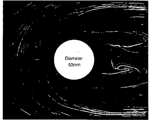
▲ 図4 平板上の円柱まわりの馬蹄渦 —限界流線—
