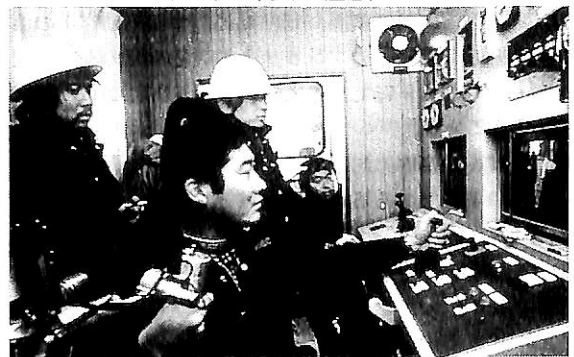
▲ 図-205 操縦盤のモニターを見ながらマスターアーム を操作する伊藤君
