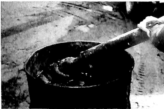
▲ 図-151 モーノポンプからのC重油の吐き出し
