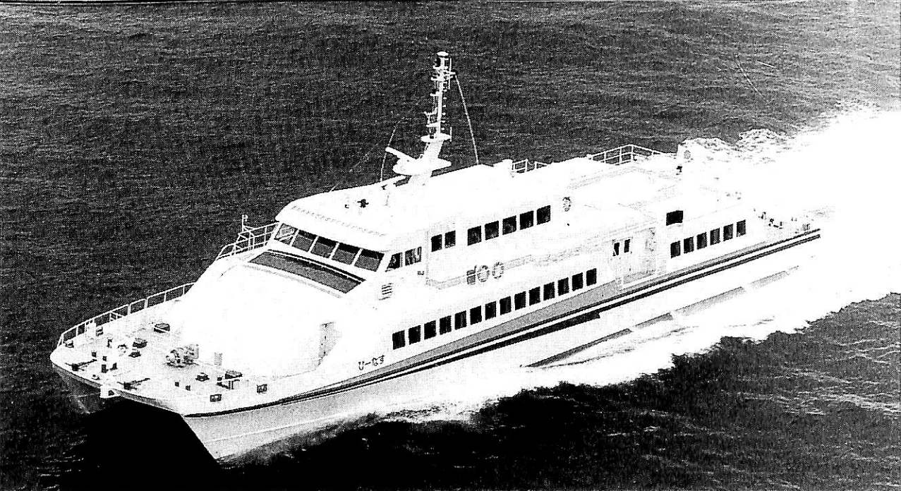
アルミ合金製高速旅客船 ひなす 船舶整備公団・共正汽船株式会社 VENUS 徳島高速船株式会社・神戸船舶株式会社
