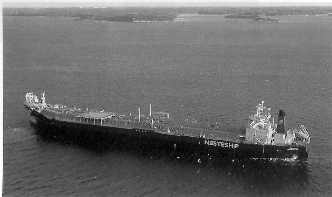
▲ “NATURA”北海航路の基準により船首ローディングと係留用の制御室がある。
