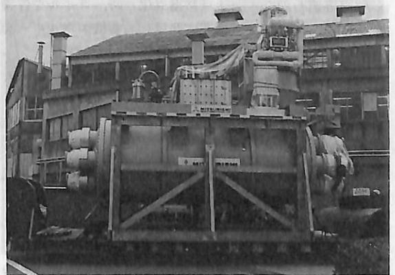
▲ スラスト外形 (6連の超電算磁石が入っている)
