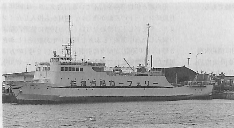
◀「さど丸」 佐渡汽船のカーフェリー第一号。'67年新潟鉄工所で建造され'69年ジャンボ化工事を行った。小さなブリッジも一風変わっていた。写真は'89年4月17日、赤泊（佐渡ヶ島）港における同船。インドネシアでもがんばる事だろう。
