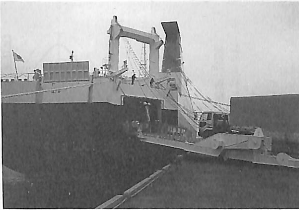
▲ 右舷後部のランプウェイから搬入されるトレーラ
