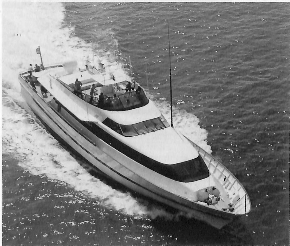
“SHERGAR” (全長47m, 排水噸230t, 最高速力 45.5 kn, 旅客設備 オーナールーム 5名, ゲスト 4名, 船員 9名)
