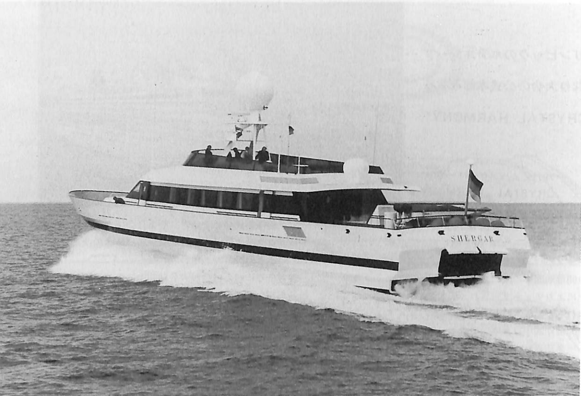
“SHERGAR” (全長47m, 排水噸230t, 最高速力 45.5 kn, 旅客設備 オーナールーム 5名, ゲスト 4名, 船員 9名)
