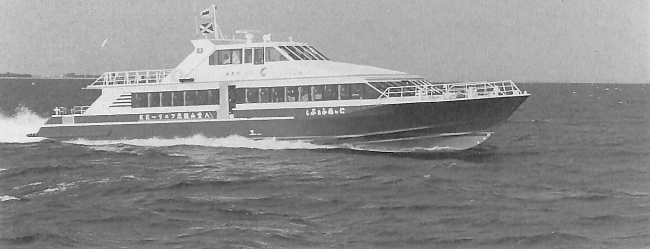
アルミ合金製高速旅客船 にいぬふあぶし 沖縄県離島海運振興株式会社 NIINUFABUSHI
