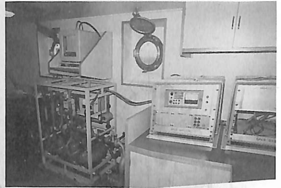
▲ ウエットラボラトリ (EPCS装置)
