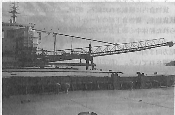
▲ブーム・コンベアおよびリフト・コンベアケーシング
