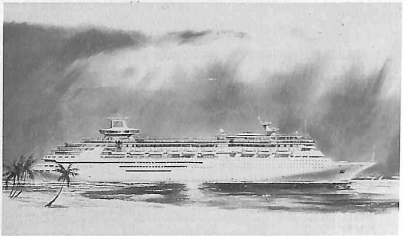
▲ “MONARCH OF THE SEAS” 74,000 GT 竣工想像画 船客用デッキ 14, 船客収容数 最高 276 名, 乗組員 827 名
