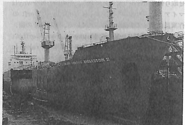
▲ Meyer Werft で延長工事中の “Sultan Mahmud Badaruddin II”
