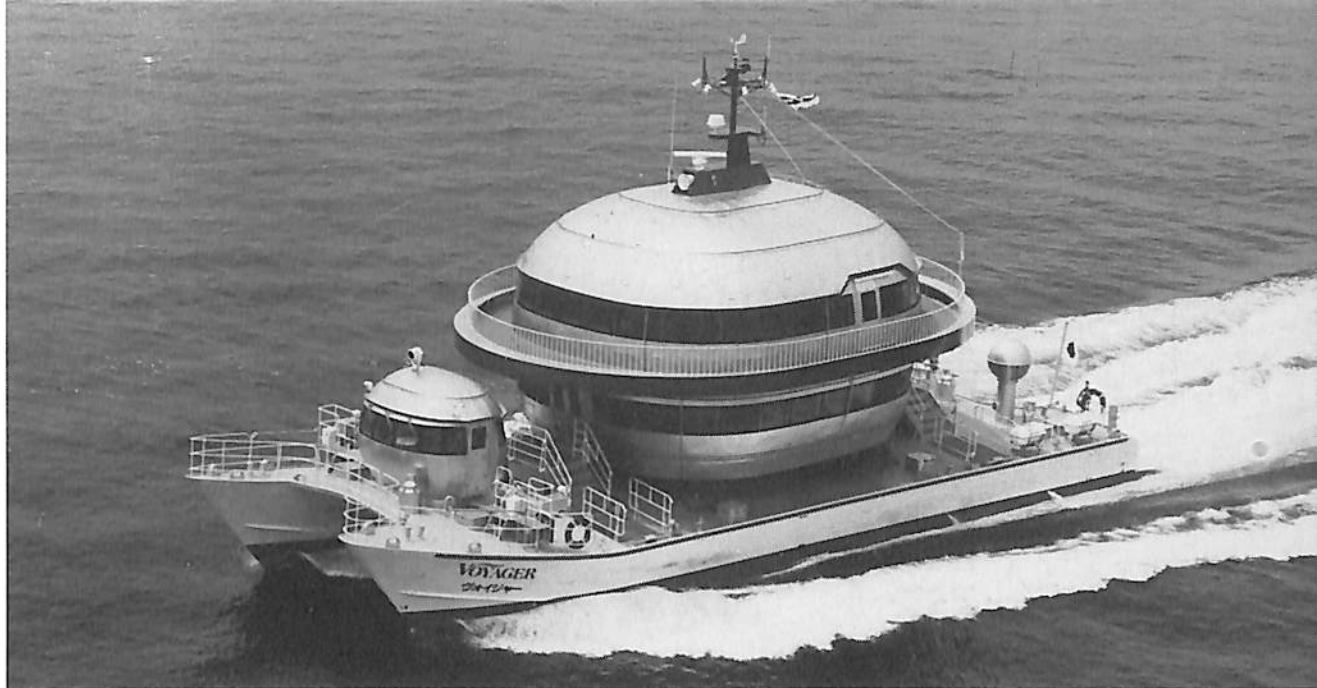
軽合金製HSCC旅客艇 ヴォイジャー 西日本海運株式会社
