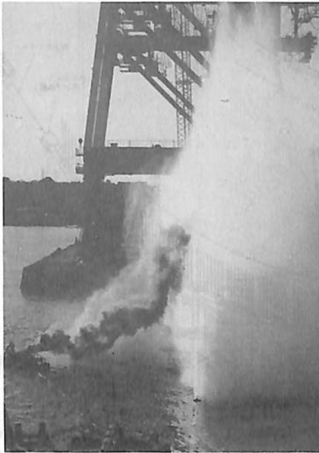
▲ 写真1 赤色発煙筒(左)による拡散可視化実験
