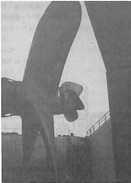
▲推進性能向上のため取り付けられた PBCF (Propeller Boss Cap Fin)
