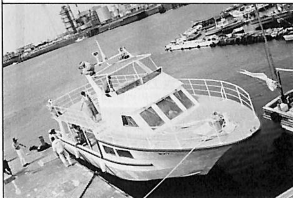
▲ DJ-130型×2基 DJ-100H型×1基 1990年7月 西表島就航 "ミス ウナリザキⅢ" 船主：ダイビングチーム うなりざき 主機：ヤンマーディーゼル 6CX-ET 350HP 4CX-ET 250HP
