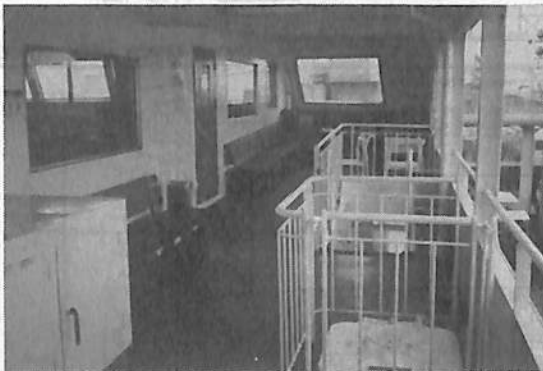
▲船橋甲板、客室右舷の暴露部（前方）を見る。 椅子の下部はライフジャケットロッカーに当てている。
