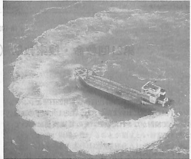
▲ シリング・ラダーによる旋回
