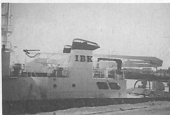
▲ 屈折式放水塔の格納状態
