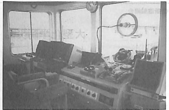
▲ 操舵室内の遠隔操縦スタンド
