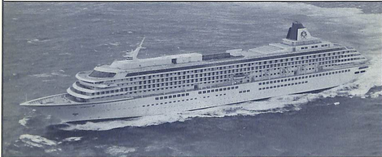
クリスタルハーモニー (49,400総トン、1990年7月環太平洋諸国間に就航) 日本郵船㈱が100%子会社のCrystal Ship (Bahamas)に保有させる日本最大豪華客船 全長約241m、乗客数約960名、航海速力22ノット、建造：三菱長崎造船所
