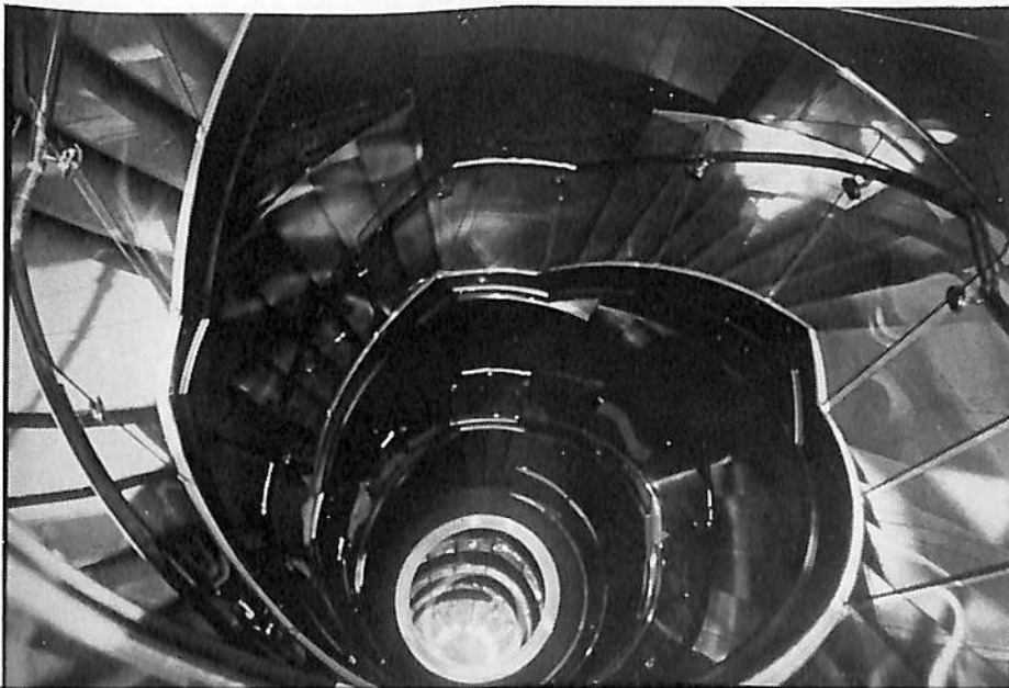
◀ 船体中央部に配された主階段、 5デッキ吹き抜けのダブルス テアである。
