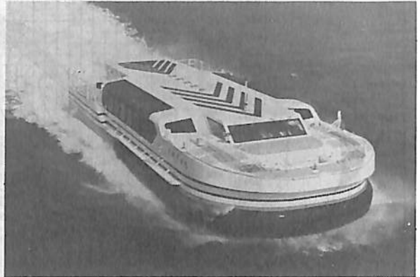
▲ 試運転時 30.37 kn を出した “すみだがわ”
