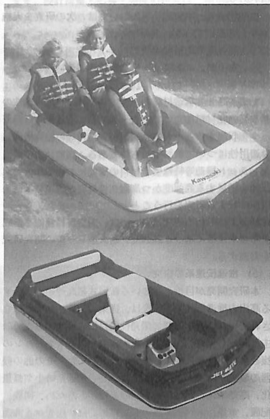
▲航走中のJET MATEと操縦席およびシート状況 最高速力 47km/h / 喫水(静止状態) 310mm(3名) / 燃料タンク 30ℓ / 乾燥重量 239kg / 乗艇定員3名
