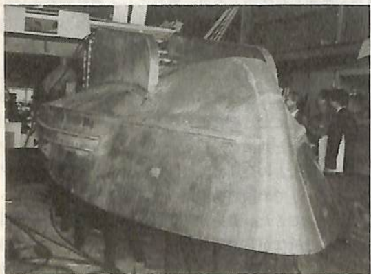
台湾・高雄で建造中のオールアルミ搭載艇
