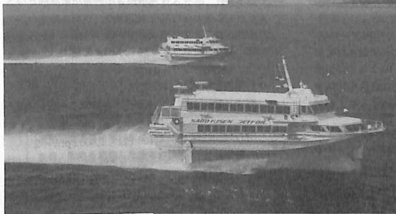
◀翼走直進中 (関西汽船・加藤汽船共有) ジェットfoil"ジェット8"
