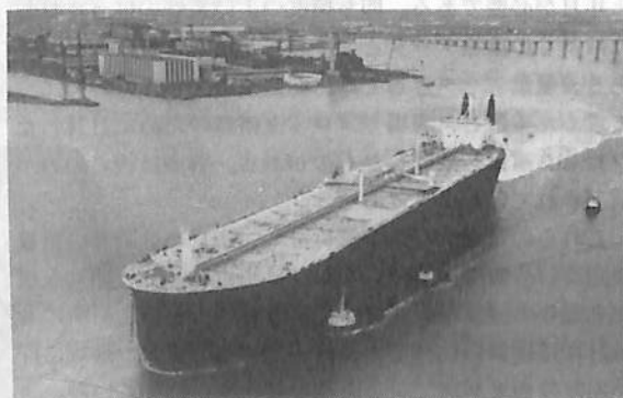
写真3・1 シリンドリカルバウ (アトランティック造船所建造 バチラス号 54万重量トン)
