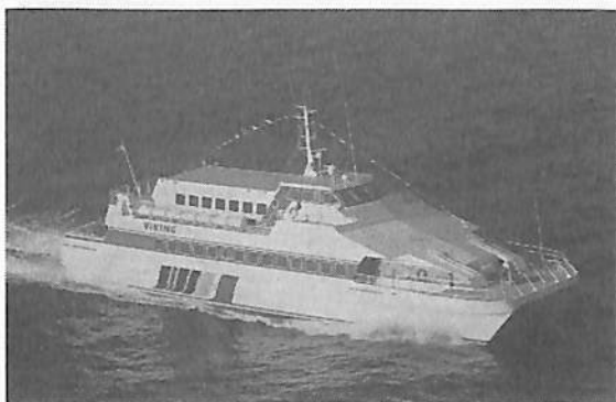
ノルウェーのオールアルミニウム合金双胴船 (399 GT・全長38.8m・速力23kn・310名乗り)
