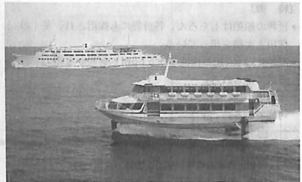
時速80kmで疾走するオールアルミニウム合金製ジェットホイール（先方は鋼船フェリー）
