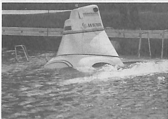
潜水時の本艇正面中央マドはビデオ付潜望装置
