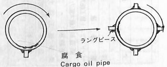
図106 テフロンUボルトスライディングパットの適用例
