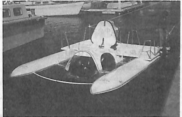
水上航行時の状態、タワー部は開けられ出入口となる
