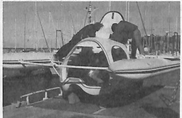
陸上での本艇バラストウエイトの状態がわかる。平面下の凹みにはライトが取付けられる
