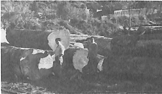
キール・フレーム材となる樺の原木 (バルセロナ郊外で自然乾燥中のもの)
