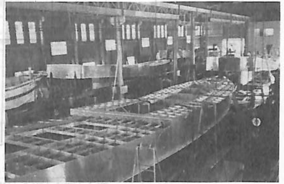
4隻同時建造のオールアルミニウム船工場
