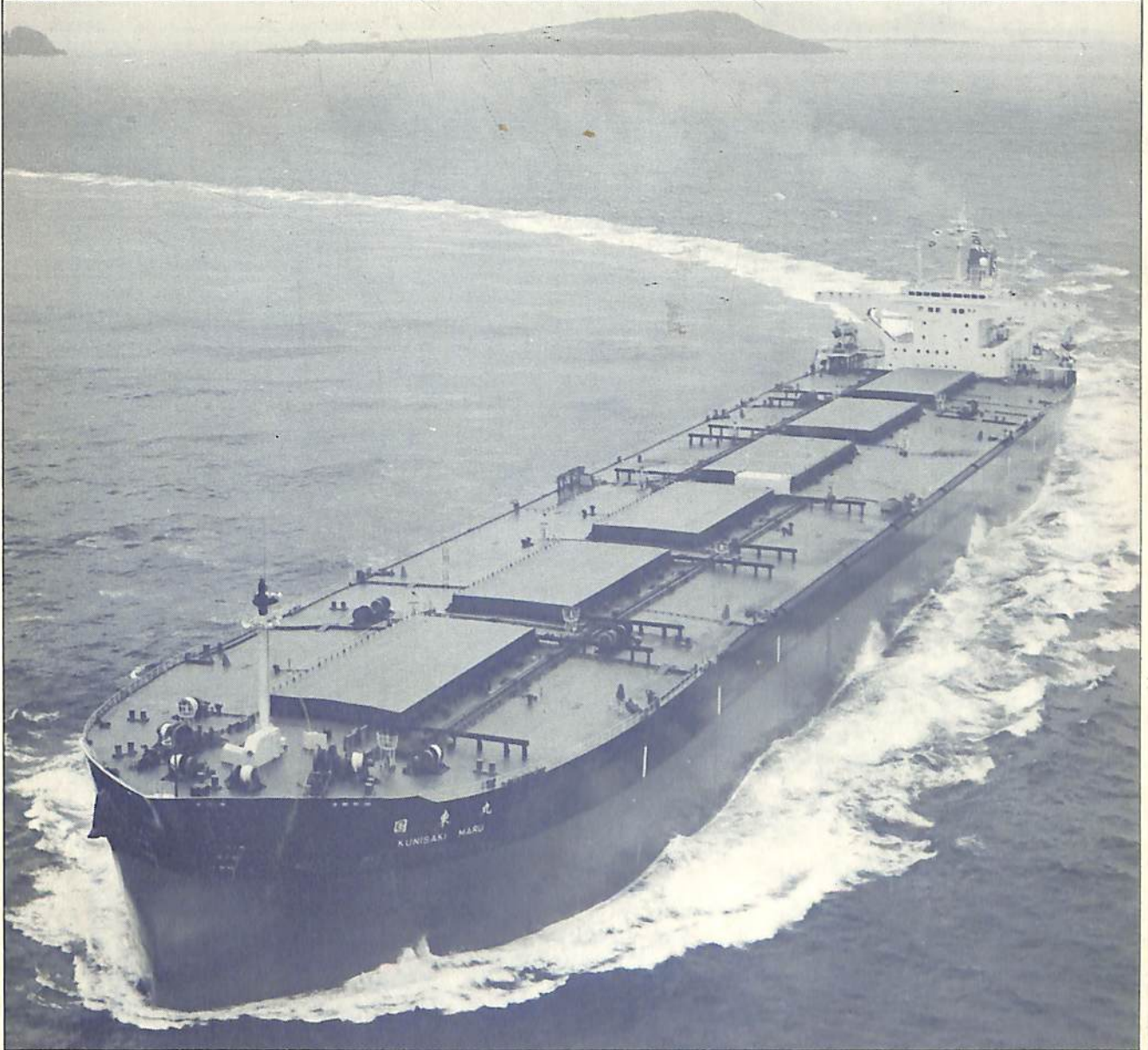
フレンド SHIPPING 向け 鉱石運搬船 / 載貨重量 227,960t / 貨物艙容積 134,983 m 3 / (試運転最大 16kn)
