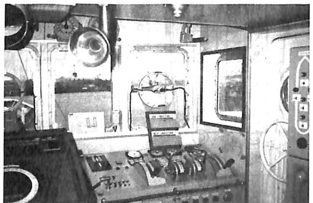
操舵室：制御盤に機関・C P Pの制御を内蔵している 上右は大型サーチ・ライト用ハンドル
