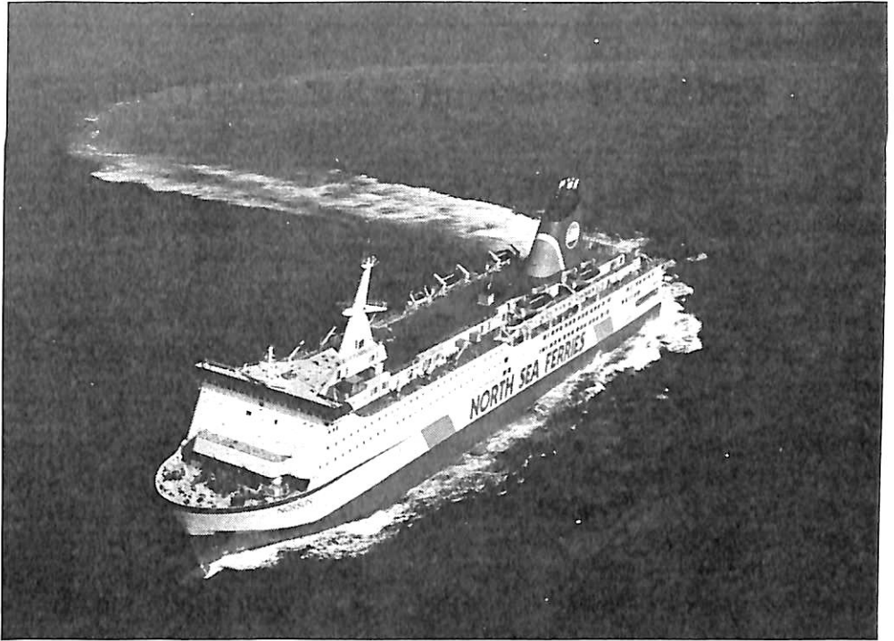
ベッカー・ラダーを使用して舵行試運転中の“NORSUN”
