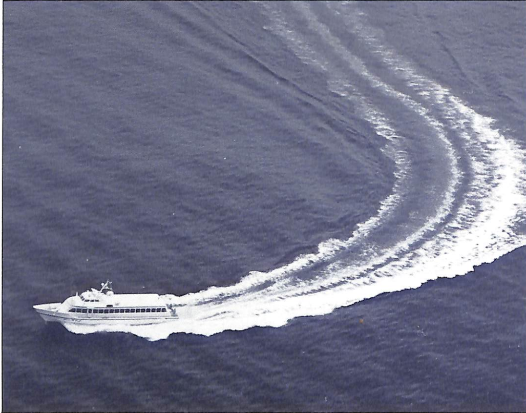
世界で最初の SSB船 型実用艇“サンライン” (全長26メートル・最高速力28ノット)
