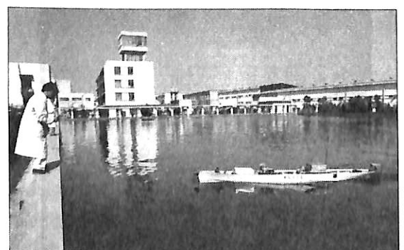
写真7 操縦性能水槽
