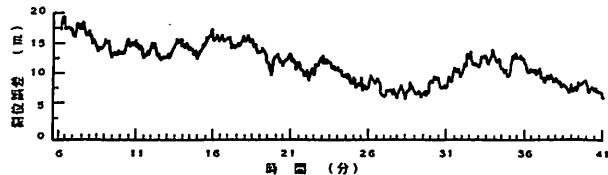
第A・7・166図 TI4100受信機の3衛星、高度ホールドモードにおける測位誤差
