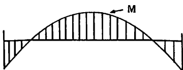
図 16・1 両端固定梁の曲げモーメント
