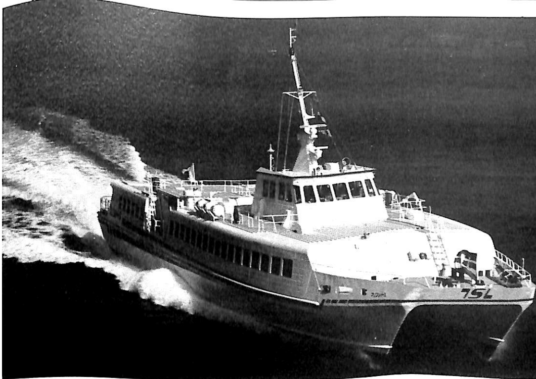
耐食アルミ合金製双胴型高速旅客船 マリン シャトル 船舶整備公団・共正汽船株式会社
