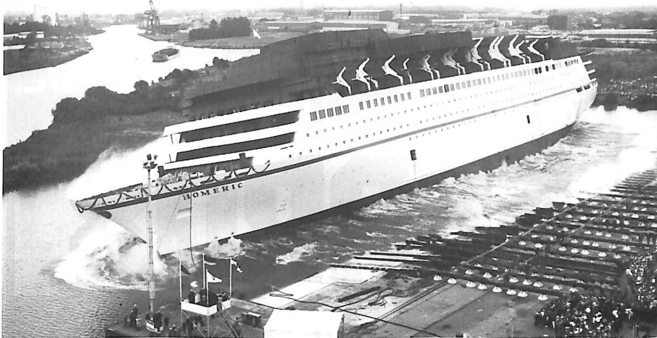
(左頁上段) 昨年9月28日マイヤ造船所で進水合図を待つ本船。スタビライザー、パウスラスターの位置が良くわかる。船体を支えている横木が一斉に下ることにより進水が開始される。手前水面が堀割の進水区域となっている。
