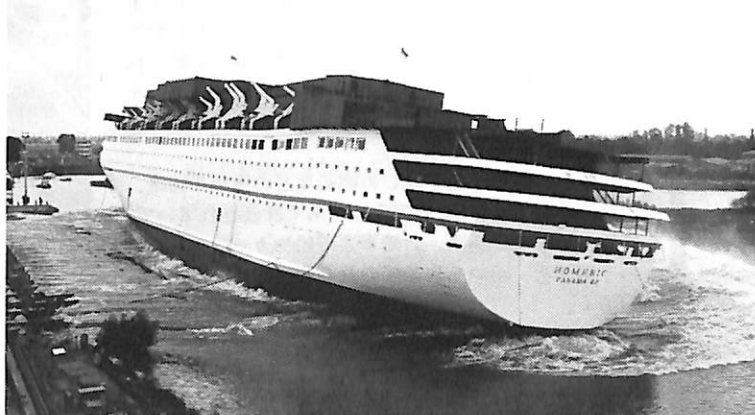
(左頁上段) 昨年9月28日マイヤ造船所で進水合図を待つ本船。スタビライザー、パウスラスターの位置が良くわかる。船体を支えている横木が一斉に下ることにより進水が開始される。手前水面が堀割の進水区域となっている。
