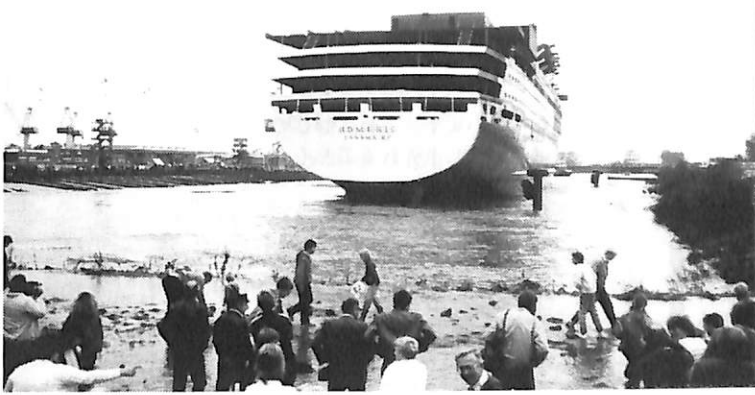
(上段から2) 船台側の後部から見た進水の一瞬。堀割の対岸に波が押し寄せている状況と船台の横木が下っている。流れ止めの支え綱は船首、船尾に一本ずつある。
